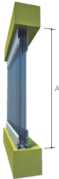
SIN VIERTEAGUAS LP = A - 40 \text{ mm} A = \text{medida luz}
